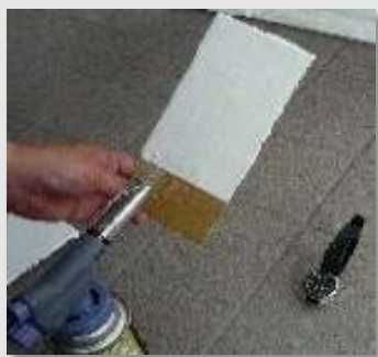
①段ボール面に、本品を塗膜し表面をバーナーで加熱
