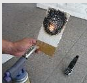
③炭化物を生成しさらに発泡が進む
